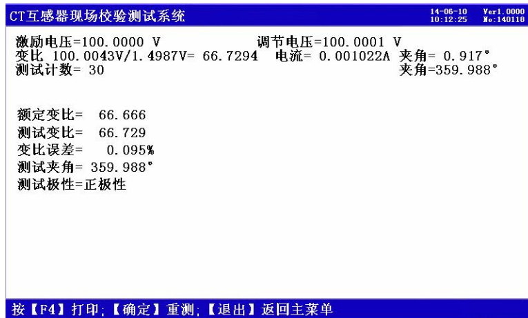
图 13、PT 变比极性测试结果界面
